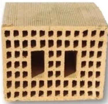
Mattoni Muro Olfattivo: 30x25 altezza 19 cm 72 FORI – Grandezza fori piccoli 1,3 cm /1,4 cm
